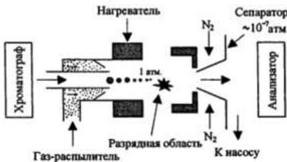
Схема источника ионов, работающего при атмосферном давлении
