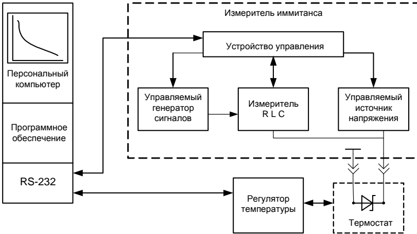
Рис. 4. Структурная схема установки для исследования ВФХ
