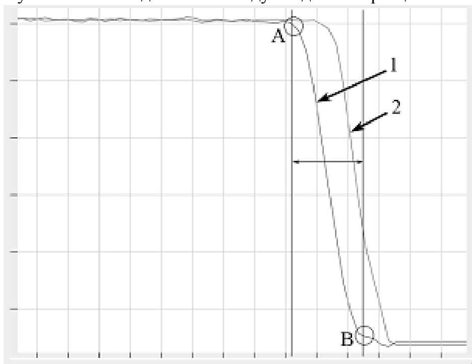
Рис. 2.6. Осциллограмма окна режима «Спектроскопия»: 1 – кривая, полученная при приближении зонда к образцу; 2 – кривая, полученная при отдалении зонда от образца
