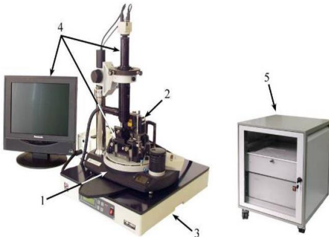
Рис. 4.1. Зондовая нанолаборатория NTEGRA: 1 – базовый блок; 2 – измерительная головка; 3 – система виброизоляции; 4 – система видеонаблюдения; 5 – система управления
