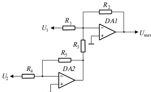
для коэффициентов передачи  $K_1=-1/3$  и  $K_2=5/6$  входных напряжений  $U_1=1\text{ В}$  и  $U_2=-2\text{ В}$ . Вычислить значение выходного напряжения  $U_{\text{ВЫХ}}$ .
