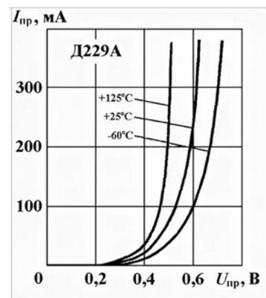
где  $U_{П}$  - напряжение источника питания (источника ЭДС);  $U_R$ ,  $U_D$  - падение напряжения на резисторе  $R$  и диоде  $VD$  соответственно,  $I_D$  - сила тока, протекающего через цепь, состоящую из последовательно включенных  $R$  и  $VD$ . Расчет выполнить для диода Д229А при температуре  $25^\circ\text{C}$  и  $U_{П}=2\text{В}$ ,  $R=100\text{Ом}$ .
