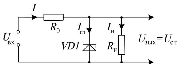
для входного напряжения  $U_{\text{ВХ}}=15\text{В}$ , тока стабилизации  $I_{\text{СТ}}=5\text{ мА}$  стабилитрона КС156А ( $U_{\text{СТ}}=5,6\text{ В}$ ), и сопротивления нагрузки  $R_{\text{Н}}=1\text{ кОм}$ .
