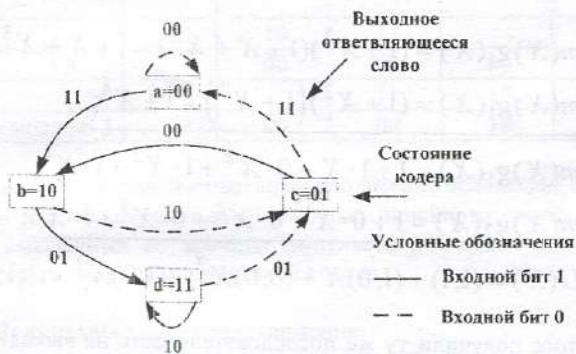
Рис. 3. Диаграмма состояний кодера (скорость кодирования 1/2 , K=3 )
