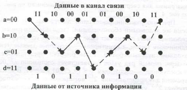
Рис. 5. Путь на решетчатой диаграмме сверточного кодера
