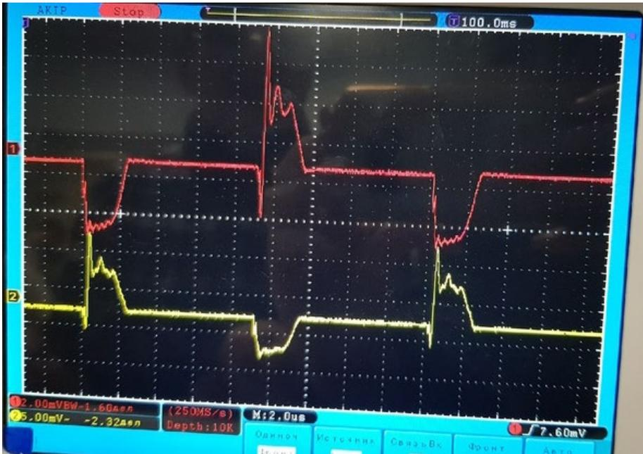
На рисунке изображены временные диаграммы напряжения на коллекторе двухтактного инвертора с внешним возбуждением (красным) и его выходного напряжения (жёлтым).
