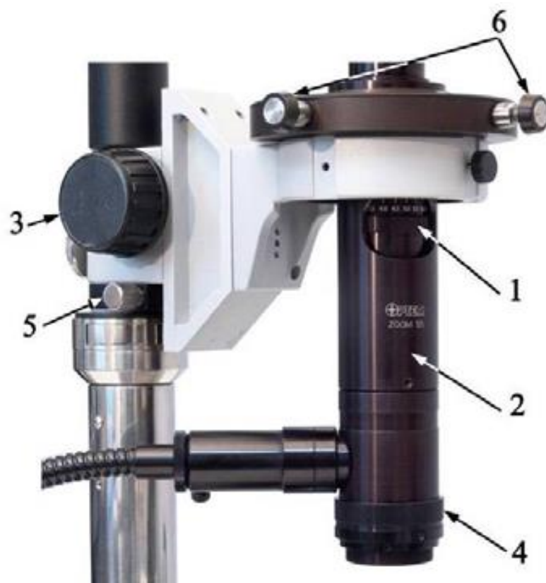
Рис. 1.11. Элементы настройки изображения: 1 – регулятор увеличения; 2 – модуль трансфокатора; 3 – ручка механизма грубой фокусировки; 4 – кольцо точной фокусировки; 5 – световодная система; 6 – юстировочные винты позиционера видеомикроскопа
