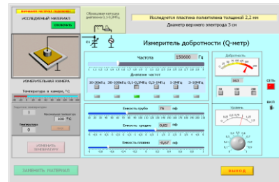
Рис. 13. Внешний вид окна для проведения измерений без подключенного к Q-метру исследуемого образца диэлектрика (а) и с подключенным образцом диэлектрика (б)
