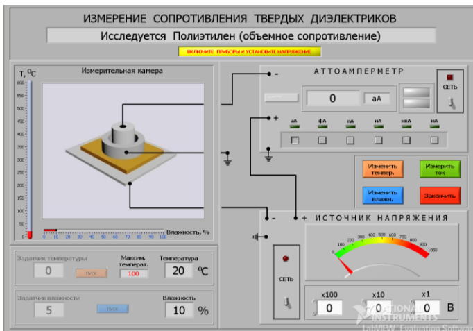
Рис. 5. Окно измерения объемного сопротивления диэлектрика
