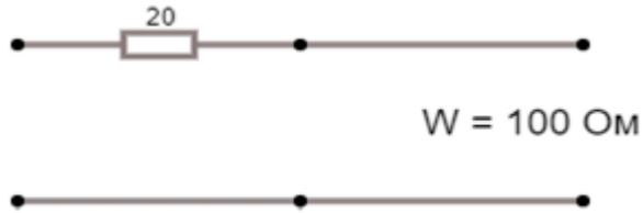
8. Определить матрицу передачи следующего четырехполюсника
