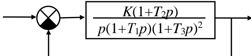
записать характеристический полином. Значения параметров принять равными:  $K = 80$ ,  $T_1 = 0,9$  с,  $T_2 = 0,09$  с,  $T_3 = 0,007$  с. Определить устойчивость системы по критерию Гурвица.
