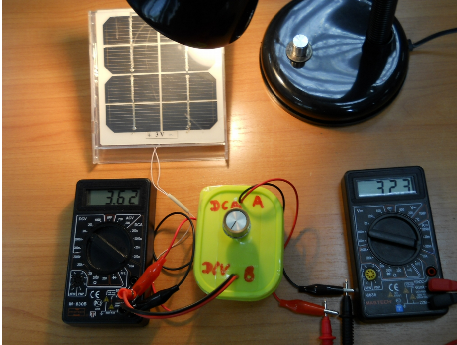
Рисунок 5. Лабораторная установка для измерения ВАХ ФЭПП ФСМ1-3
