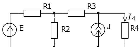
НСоставить систему уравнений по законам Кирхгофа для определения токов в ветвях схемы: для мгновенных значений и в установившемся режиме. Рассчитать токи.
