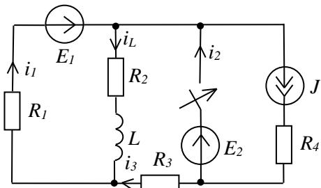
Рассчитать токи после коммутации классическим и операторным методами, построить их графики
