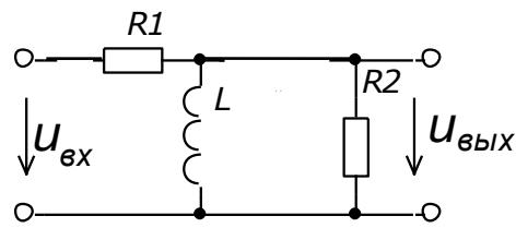
По заданной передаточной функции  $H(p)$  найти переходную характеристику  $h(t)$  и импульсную характеристику  $g(t)$ . Провести проверку найденных характеристик.
