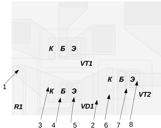
Рис. 1.2. Фрагмент топологии микросхемы с биполярными транзисторами малой мощности: VD1 – диод (транзистор в диодном включении); VT1 , VT2 – транзисторы; R1 , R2 – диффузионные резисторы; 1 – контактное окно к диффузионным резисторам; 2 – p -область разделительной диффузии; 3...5 – контуры контактных окон к соответственно коллектору, базе, эмиттеру; 6 ... 8 – области коллектора, базы, эмиттера
