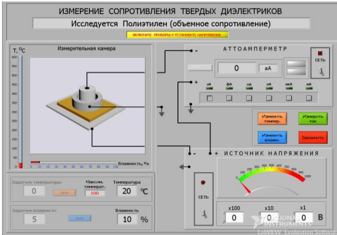
Рис. 5. Окно измерения объемного сопротивления диэлектрика
