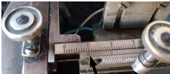
Рис.10. Механизм микрометрической подачи образца
