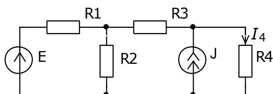
Составить систему уравнений по законам Кирхгофа для определения токов в ветвях схемы: для мгновенных значений и в установившемся режиме. Рассчитать токи.
