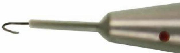
Рис. 9. Установка заготовки в капилляр, отмеченный красной точкой
