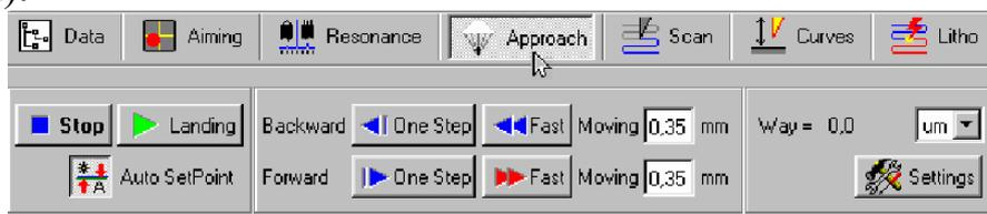
2. Проверьте состояние кнопки автоматической установки параметра **Set Point**. Кнопка **Auto SetPoint** должна быть во включенном состоянии:
