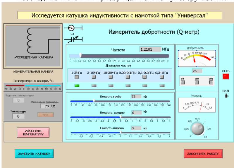
Рис. 8. Окно управления прибором Q-метр
