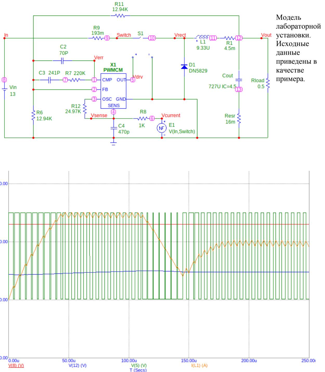
Временные диаграммы сигналов понижающего преобразователя напряжения. Здесь:
