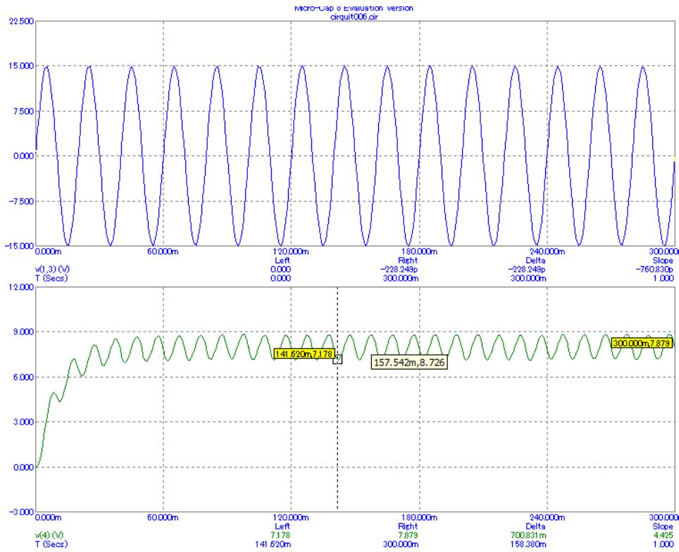
4. По графикам напряжения на генераторе и на нагрузке оцените величину пульсаций
