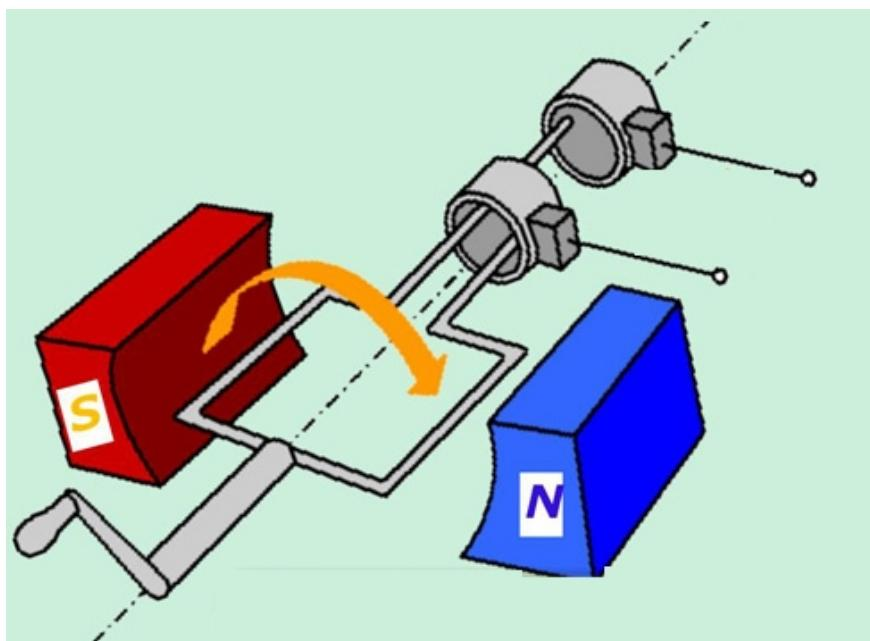
3. Принцип действия генератора переменного тока
