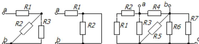
3. Вычислить токи и напряжения в схемах рис., если  $E=100\text{ В}$ ,  $R_1=100\text{ Ом}$ ,  $R_2=10\text{ Ом}$ ,  $J=1\text{ А}$ .
