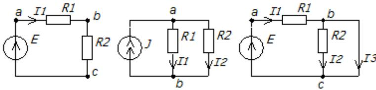
4. Для делителя напряжения получить формулу и построить график зависимости напряжения  $U_n$  от  $R_x$  для  $R_n=R$ .
