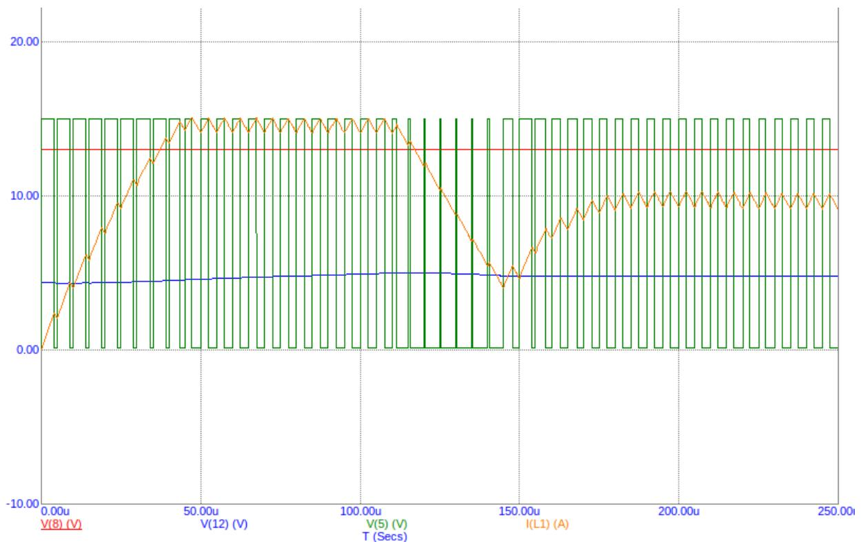
Временные диаграммы сигналов понижающего преобразователя напряжения. Здесь:
