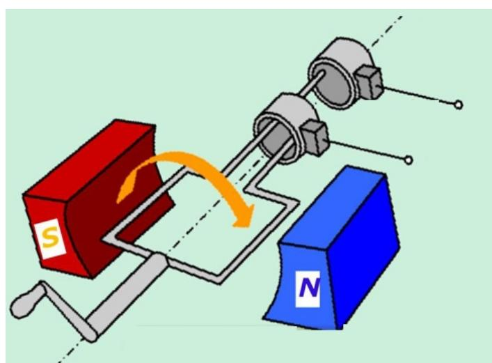
3. Принцип действия генератора
