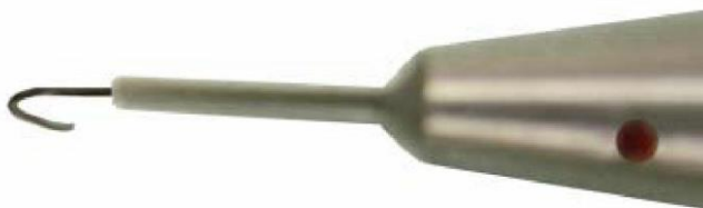
Рис. 9. Установка заготовки в капилляр, отмеченный красной точкой
