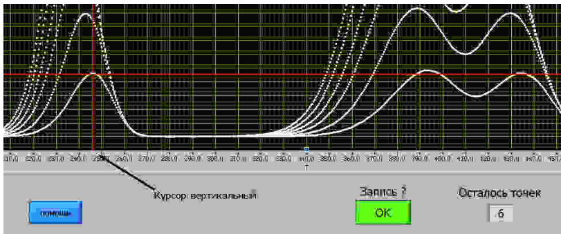
Рис. 10. Часть отображаемой лицевой панели со спектром РСГУ и курсорами
