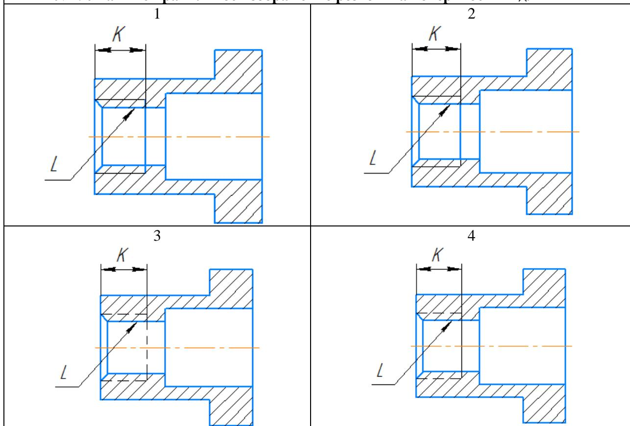
**№8. Укажите правильное изображение резьбового соединения следующих деталей:**
