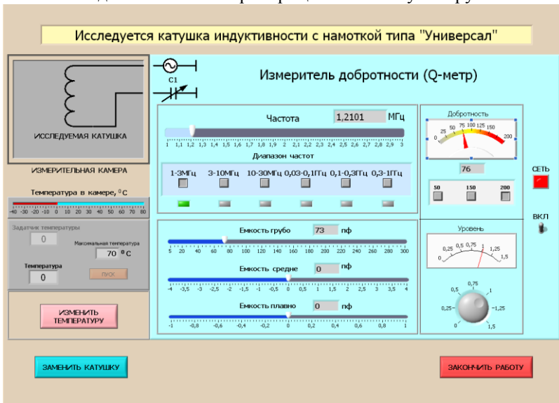
Рис. 8. Окно управления прибором Q-метр
