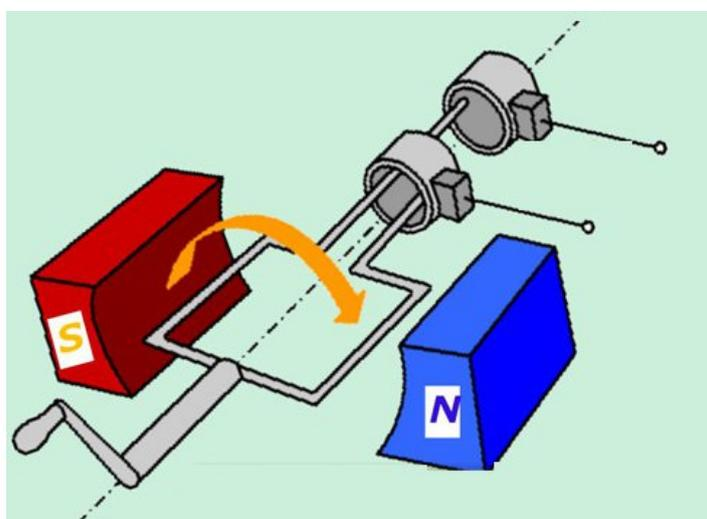
3. Принцип действия генератора переменного тока
