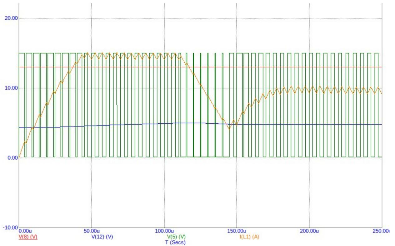
Временные диаграммы сигналов понижающего преобразователя напряжения. Здесь:
