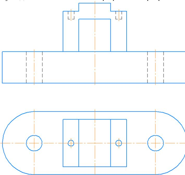
**Задача 2.** Завершите изображение, соединив на месте вида спереди половину вида и половину разреза. Проставьте размеры.
