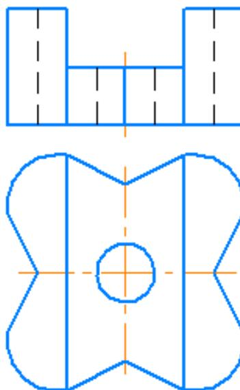
**Задание 3.** Завершите изображение, соединив половину вида и половину разреза. Изобразите резьбу метрическую с крупным шагом. Проставьте размеры.
