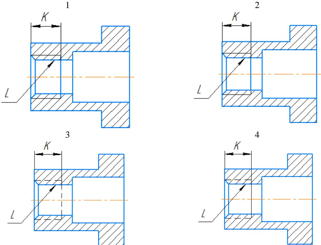
№8. Укажите правильное изображение резьбового соединения следующих деталей:
