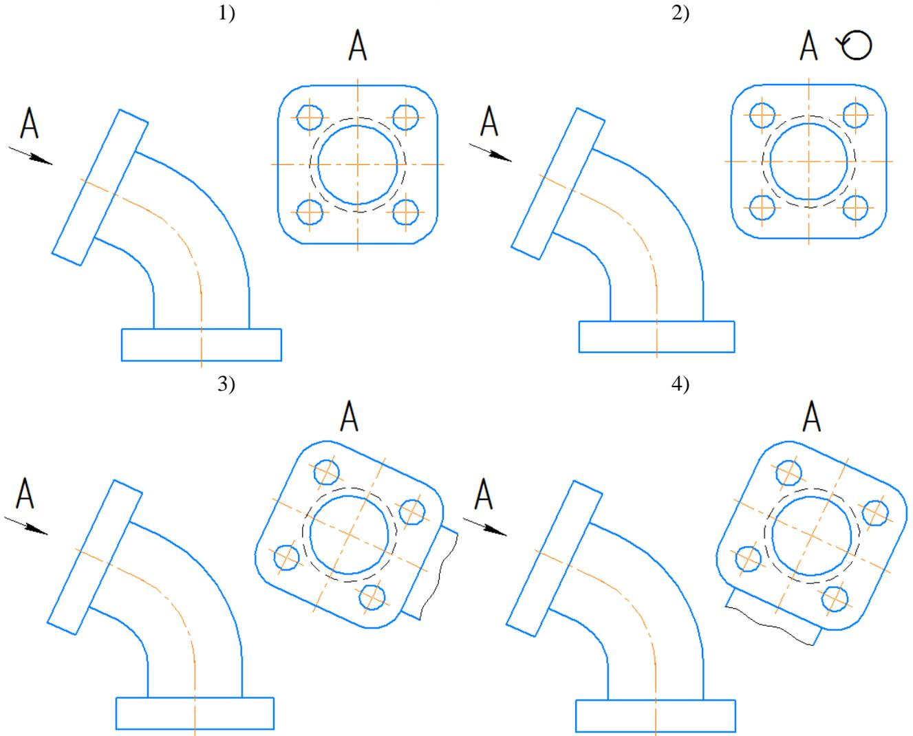
**№23 Наклонный разрез**
