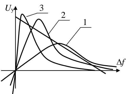
4. При какой характеристике частотного дискриминатора, 1, 2 или 3, полоса удержания будет максимальной?
