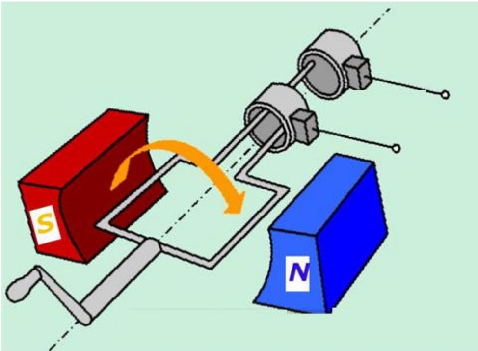
3. Принцип действия генератора переменного тока
