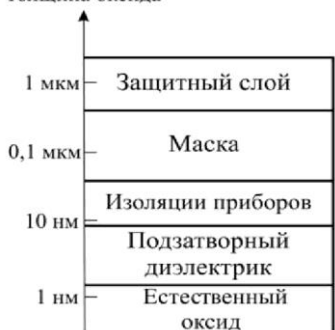
Рис. 1.1. Применение SiO 2 в кремниевой технологии
