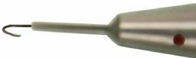
Рис. 9. Установка заготовки в капилляр, отмеченный красной точкой
