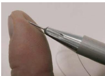
Рис. 6. Сгибание конца проволоки (а), определение длины заготовки (б)
