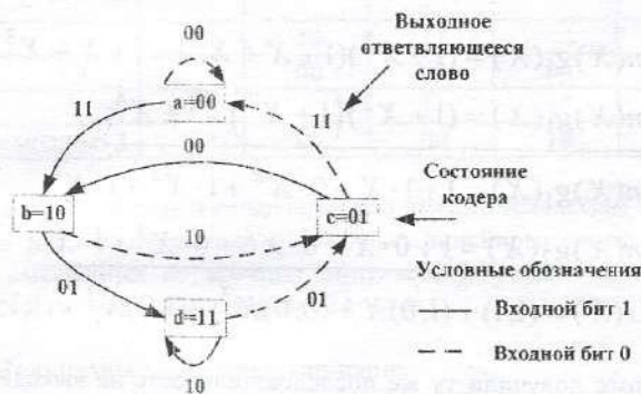
Рис. 3. Диаграмма состояний кодера (скорость кодирования 1/2 , K=3 )
