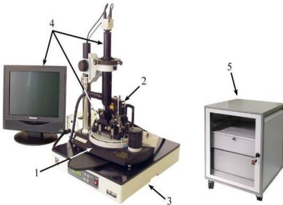
Рис. 4.1. Зондовая нанолaborатория NTEGRA: 1 – базовый блок; 2 – измерительная головка; 3 – система виброизоляции; 4 – система видеонаблюдения; 5 – система управления
