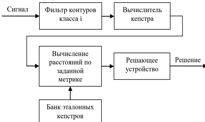
Рис.4.2. Структурная схема фрактального обнаружителя с выделением контуров
