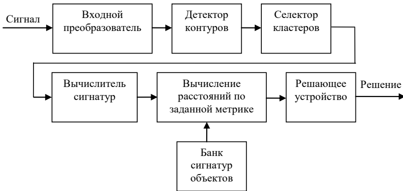
Рис.4.3. Фрактальный обнаружитель радиосигналов
