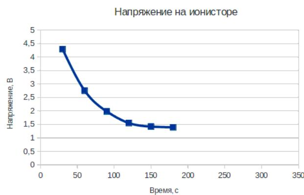
График напряжения на ионисторе до прерывания процесса его разряда
