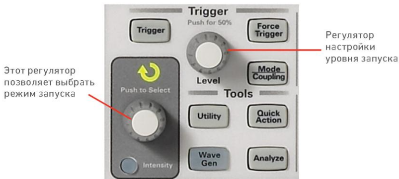
Рис. 7. Блок органов управления системой запуска осциллографа
