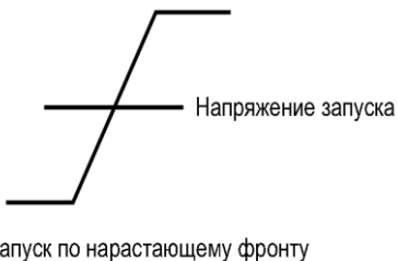
Рис. 6. Графическое представление запуска по нарастающему фронту сигнала
