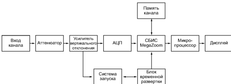
Рис. 2. Архитектура цифрового осциллографа Keysight серии InfiniiVision 2000 X
