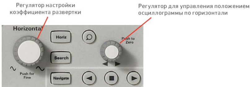
Рис. 5. Блок органов управления системой горизонтального отклонения осциллографа
