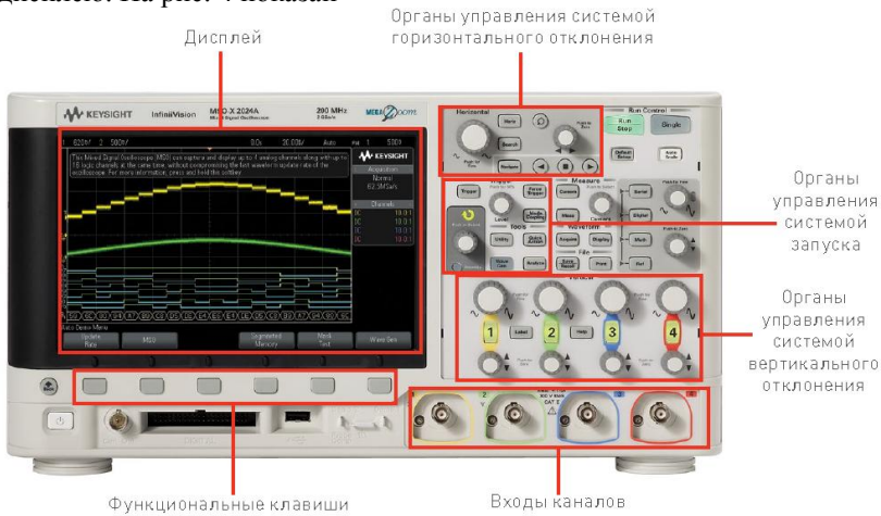
Рис. 3. Передняя панель осциллографа
