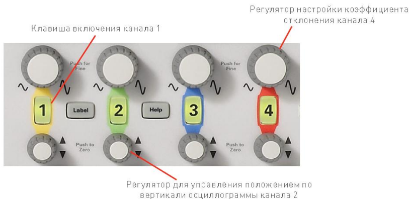
Рис. 4. Блок органов управления системой вертикального отклонения осциллографа
