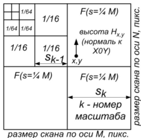
Рис. 17. Иллюстрация разбиения изображения поверхности на сегменты различного размера
