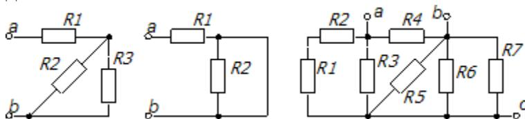
3. Вычислить токи и напряжения в схемах рис., если  $E=100 \text{ В}$ ,  $R_1=100 \Omega$ ,  $R_2=10 \Omega$ ,  $J=1 \text{ А}$ .
