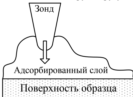
Рис. 2.2. Притяжение зонда к поверхности за счет капиллярных сил
