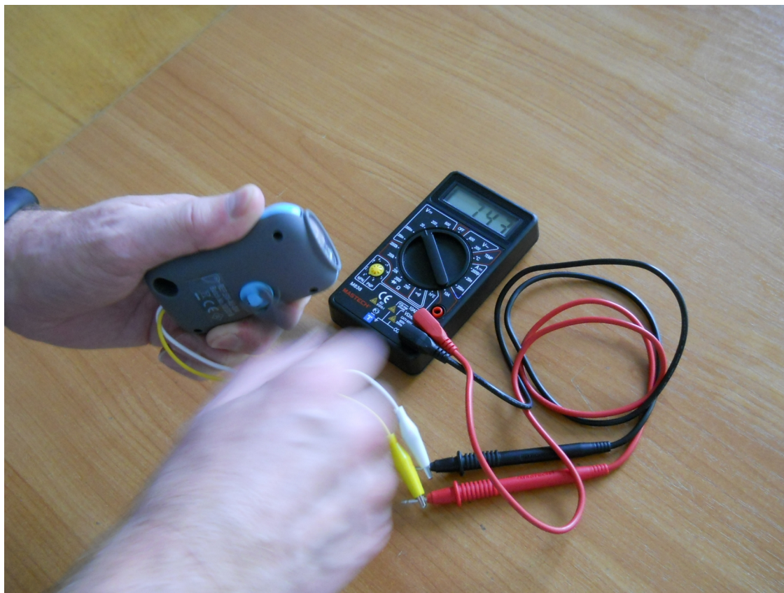
Рисунок 7. Измерение напряжения холостого хода.
