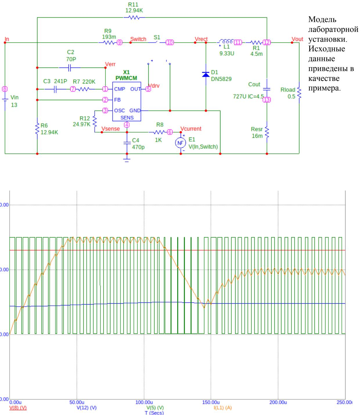
Временные диаграммы сигналов понижающего преобразователя напряжения. Здесь:
