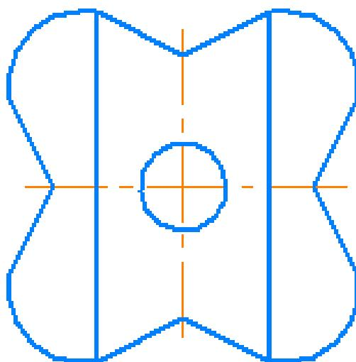
**Задание 3.** Завершите изображение, соединив половину вида и половину разреза. Изобразите резьбу метрическую с крупным шагом. Проставьте размеры.
