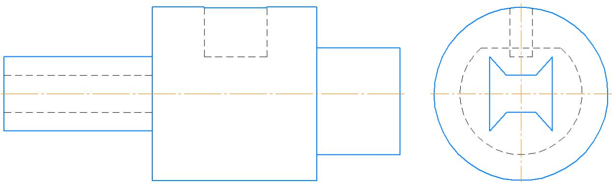
**Задача 7.** Для данной симметричной детали выполнить три вида: на главном виде совместить половину главного вида с половиной фронтального разреза; на виде слева совместить половину вида слева с половиной профильного разреза. Проставить необходимые исполнительные размеры. Заполнить основную надпись.
