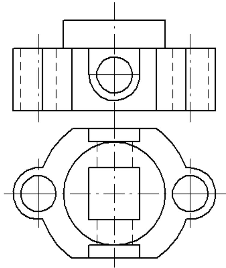
**Задача 8.** Главный вид заменить предложенным сложным ломано-ступенчатым разрезом. Начертить вид сверху, вид слева. Проставить необходимые исполнительные размеры. Заполнить основную надпись.
