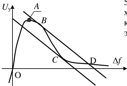
5. Укажите участок дискриминационной характеристики частотного дискриминатора, который соответствует режиму эффективной автоподстройки частоты.
