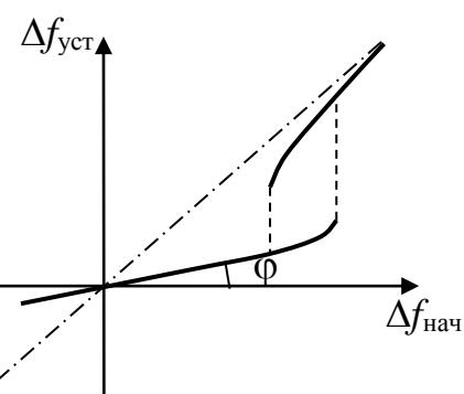
3. На рисунке изображена статическая характеристика. Как связан коэффициент автоподстройки  $K_{\text{ап}}$  с углом наклона статической характеристики  $\phi$ ?
