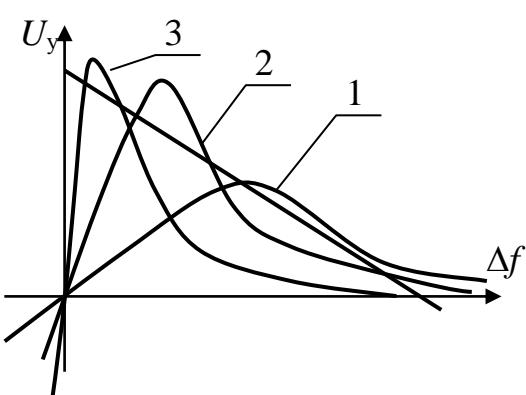
4. При какой характеристики частотного дискриминатора, 1, 2 или 3, полоса удержания будет максимальной?
