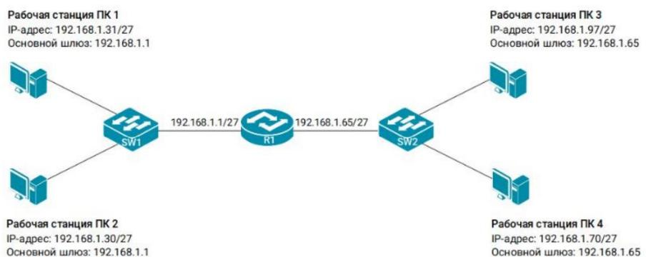
3. На рисунке показана схема сети. Рабочая станция ПК 4 может обмениваться данными с рабочей станцией ПК 2, но при этом соединение с ПК 3 отсутствует. Укажите причину проблемы.
