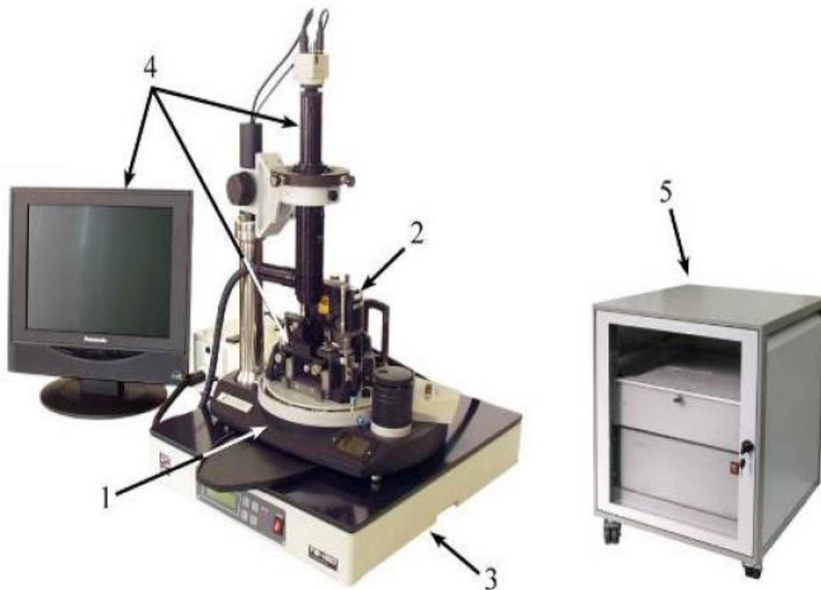
Рис. 4.1. Зондовая нанолaborатория NTEGRA: 1 – базовый блок; 2 – измерительная головка; 3 – система виброизоляции; 4 – система видеонаблюдения; 5 – система управления
