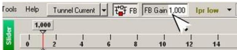
2. Определите значение коэффициента **FB Gain**, при котором начинается генерация. Начало генерации регистрируется по резкому увеличению переменной составляющей сигнала **IprLow**:
