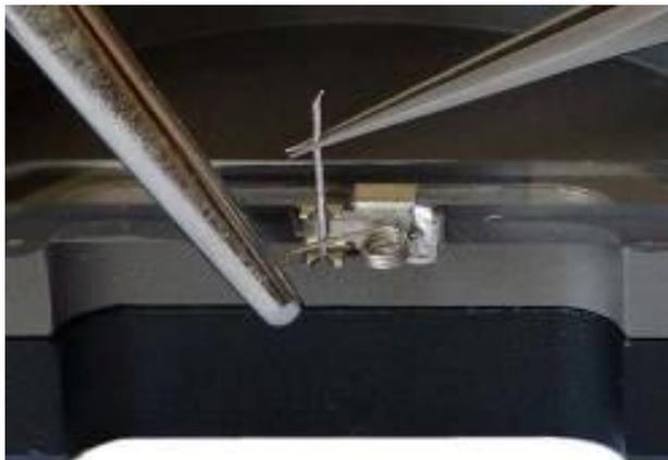
4) вставьте зонд в держатель тупым концом так, чтобы острый конец выступал за край держателя не более чем на 3-4 мм;
