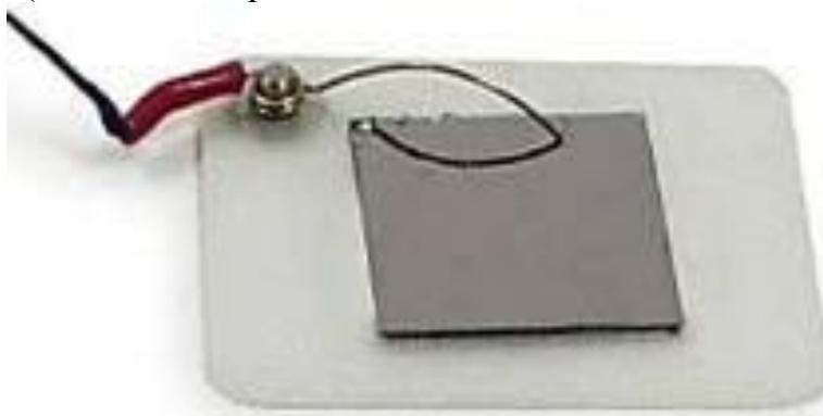
4. Пинцетом поверните контактную пружину для подачи туннельного напряжения и зафиксируйте её на краю образца так, чтобы центр образца оставался свободным.
