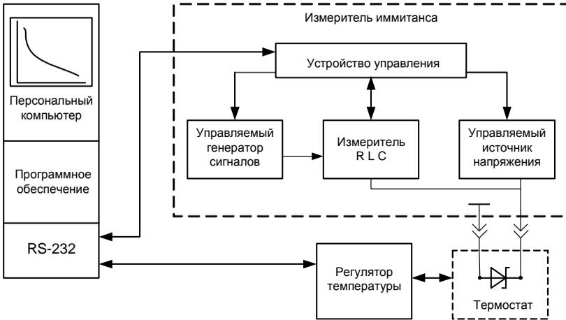
Рис. 4. Структурная схема установки для исследования ВФХ
