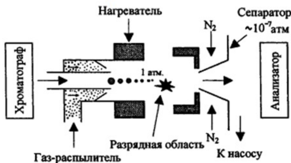
Схема источника ионов, работающего при атмосферном давлении
