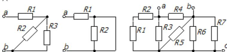
3. Вычислить токи и напряжения в схемах рис., если  $E=100 \text{ В}$ ,  $R_1=100 \Omega$ ,  $R_2=10 \Omega$ ,  $J=1 \text{ А}$ .
