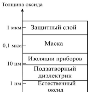
Рис. 1.1. Применение \text{SiO}_2 в кремниевой технологии
