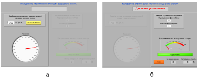
Рис. 8. Окна управления насосом (а) и измерения напряжения пробоя воздушного зазора (б)
